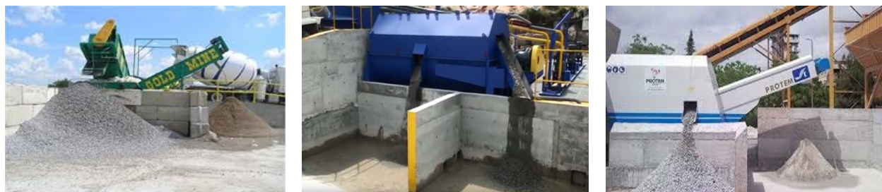
شكل (6) إعادة تدوير الخرسانة في حالتها الطازجة بالطرق الميكانيكية
