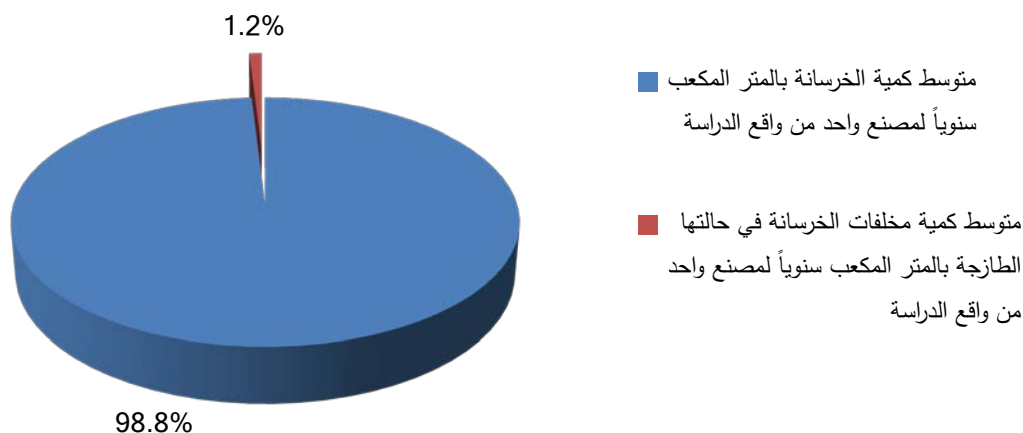
شكل (7) نسبة كمية مخلفات الخرسانة الطازجة من إجمالي إنتاج الخرسانة
