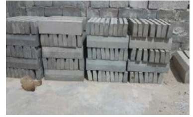
استخدام الخرسانة في تصنيع بردورات الطرق والحدائق
